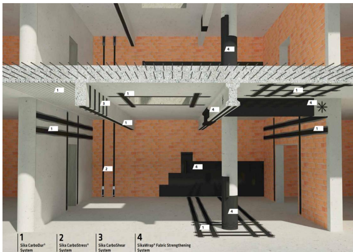
Slika 5 Slikoviti prikaz načina ojačanja lamelama od FRP-a (*tipa kao navedeni ili jednakovrijedan proizvod)
