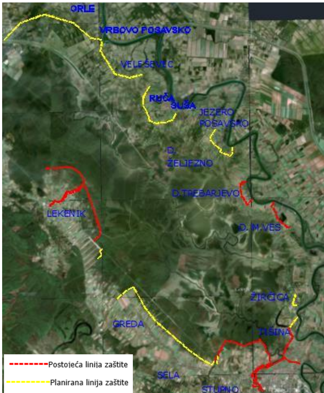
Slika 2.32 Situacijski prikaz rješenja zaštite Odranskog polja – podvarijanta 3
