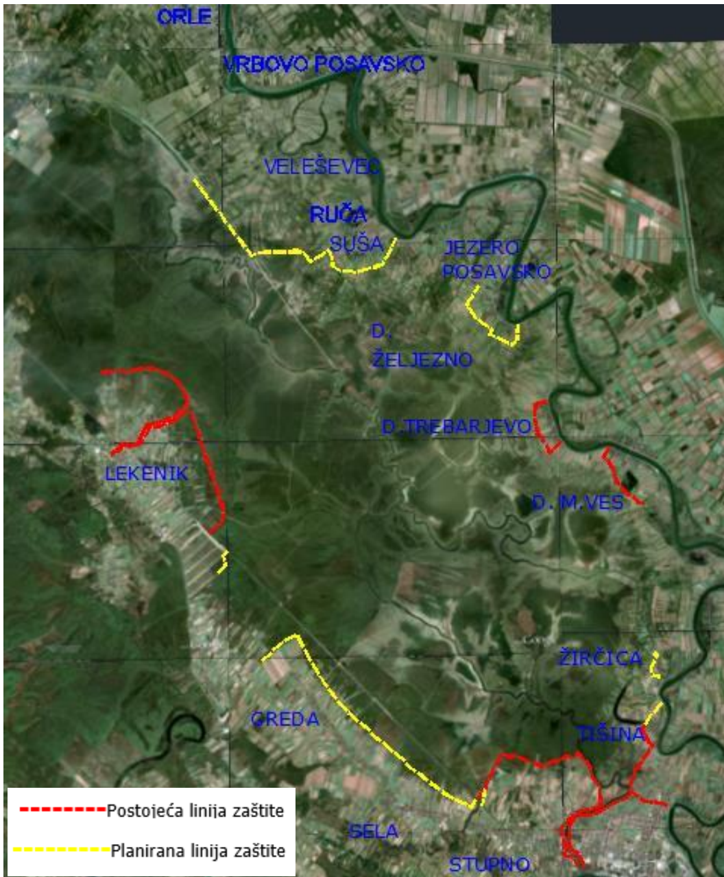
Slika 2.31 Situacijski prikaz rješenja zaštite Odranskog polja – podvarijanta 2
