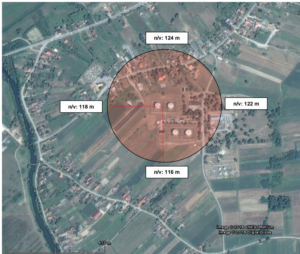
Slika 11. Odnos nadmorskih visina na krajnjim točkama zone utjecaja u najgorem mogućem slučaju
