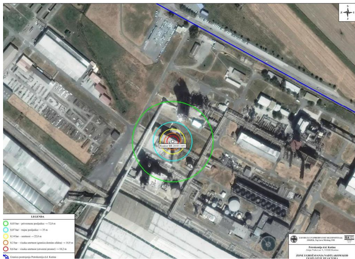
Slika 13. Zone ugrožavanja nadtlakom kod eksplozije reaktora– scenarij III.2.
